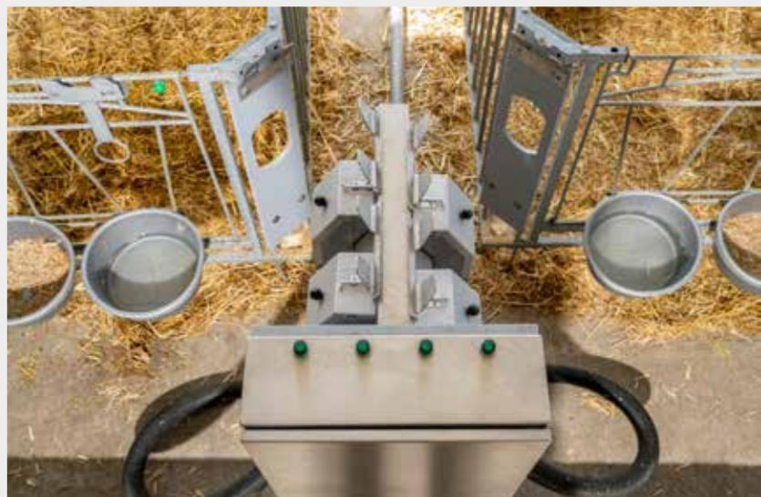
Zum Tränken werden die Nuckel einfach an die Einzelbox gehangen. Werden sie nicht benötigt oder das Iglu gereinigt, können sie an der entsprechenden Halterung der fixiert werden.
