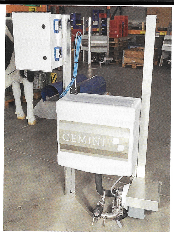
Statt einem Spülautomaten je Roboter gibt es künftig zentral diese Reinigungseinheit.
